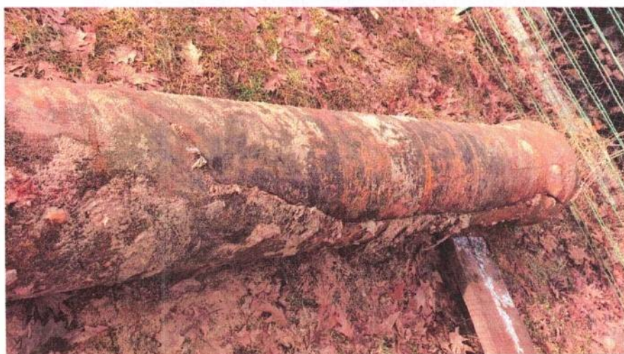
Fot. 12,13. Pęknięcia rurociagu.
