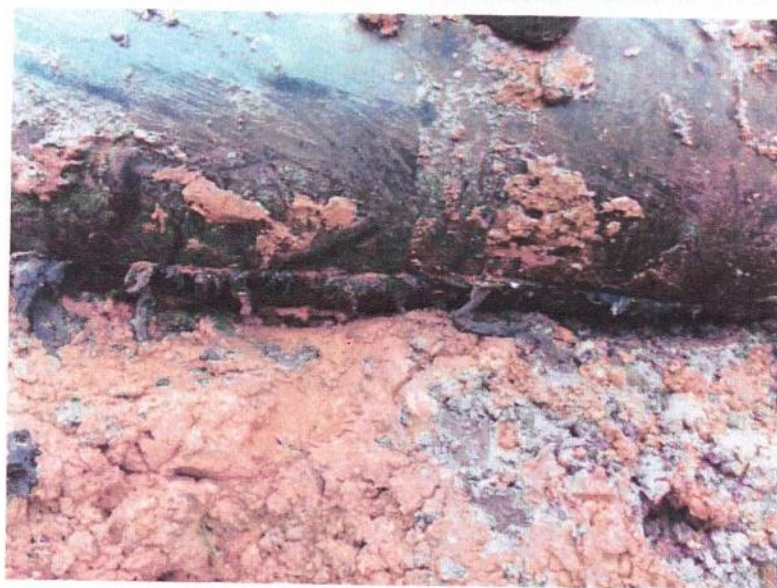
Fot. 1,2. Warunki gruntowo-wodne uszkodzonego rurociągu.
