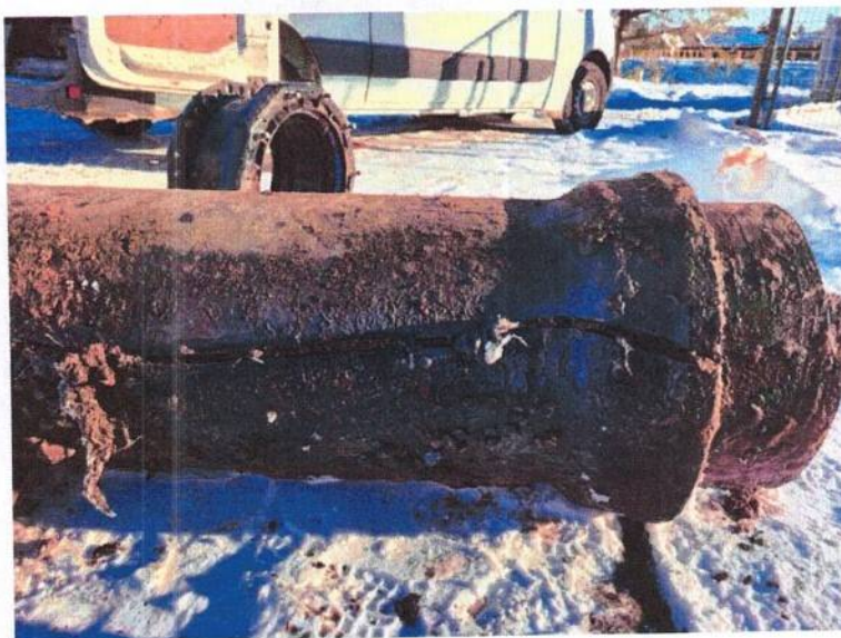
Fot. 3,4,5. Widoczne pęknięcie wzdłużne uszkodzonego rurociągu.
