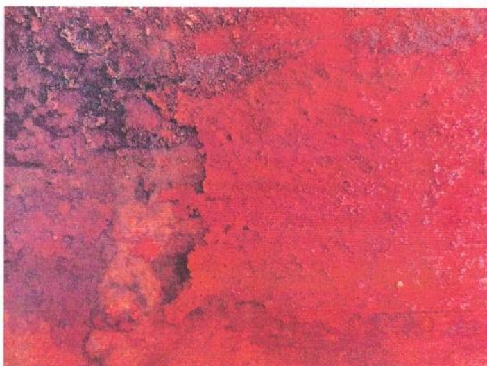
Fot. 14,15,16,17. Korozja powłoki wewnętrznej i zewnętrznej rurociągu
